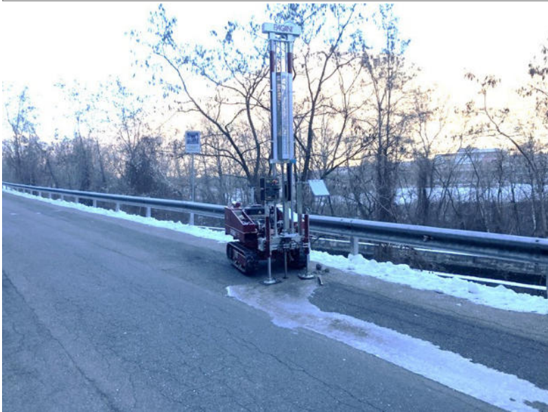
Tracciamento del metanodotto Perosa-Aosta per il posizionamento delle prove DPSH (Novembre 2021)
