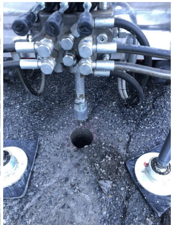
Tracciamento del metanodotto Perosa-Aosta per il posizionamento delle prove DPSH (Novembre 2021)
