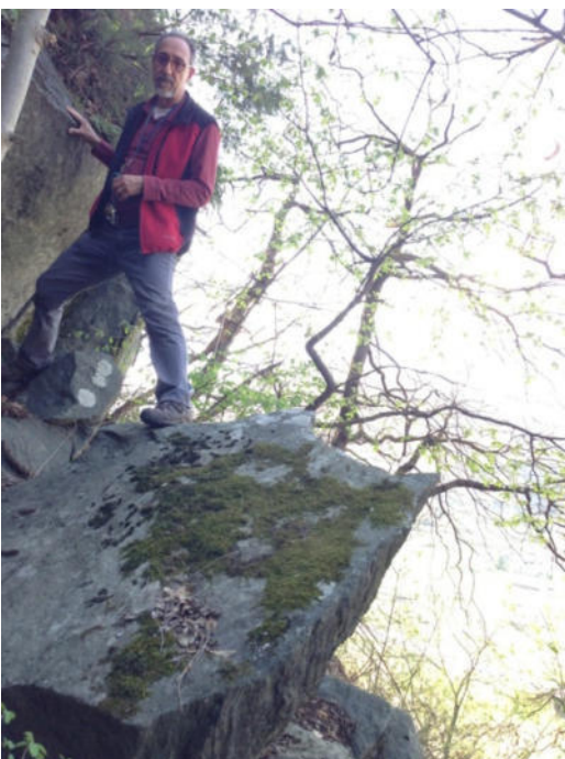
Foto 9: Blocchi e comparti rocciosi fratturati in corrispondenza dell'affioramento roccioso di quota 550m, dove sono presenti comparti di roccia fratturata e blocchi penzolanti al piede dell'affioramento (situazione E). In primo piano il blocco n.4 (Vd. tabella blocchi)
