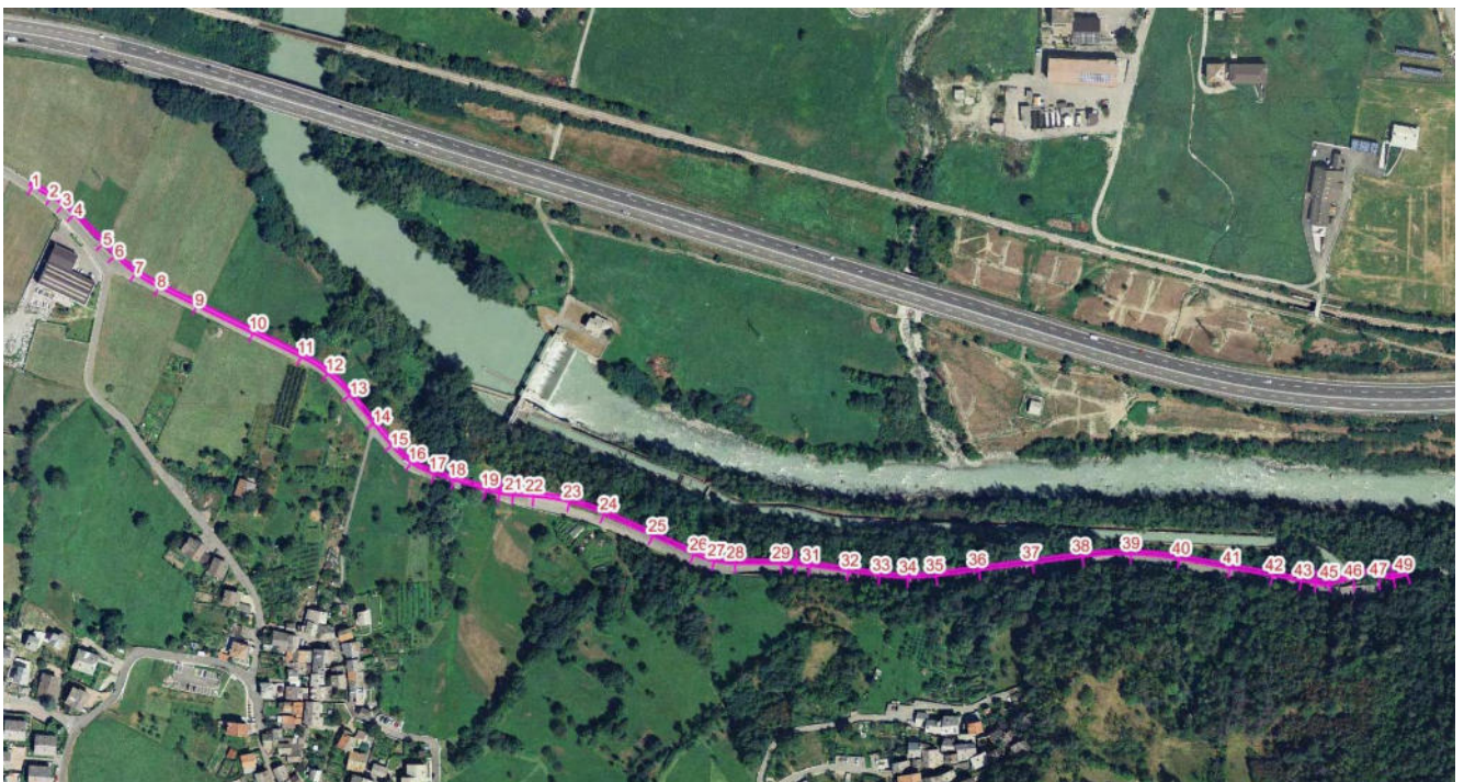
Figura 1 - Estratto cartografico del tratto di pista ciclabile con indicate le sezioni di progetto
