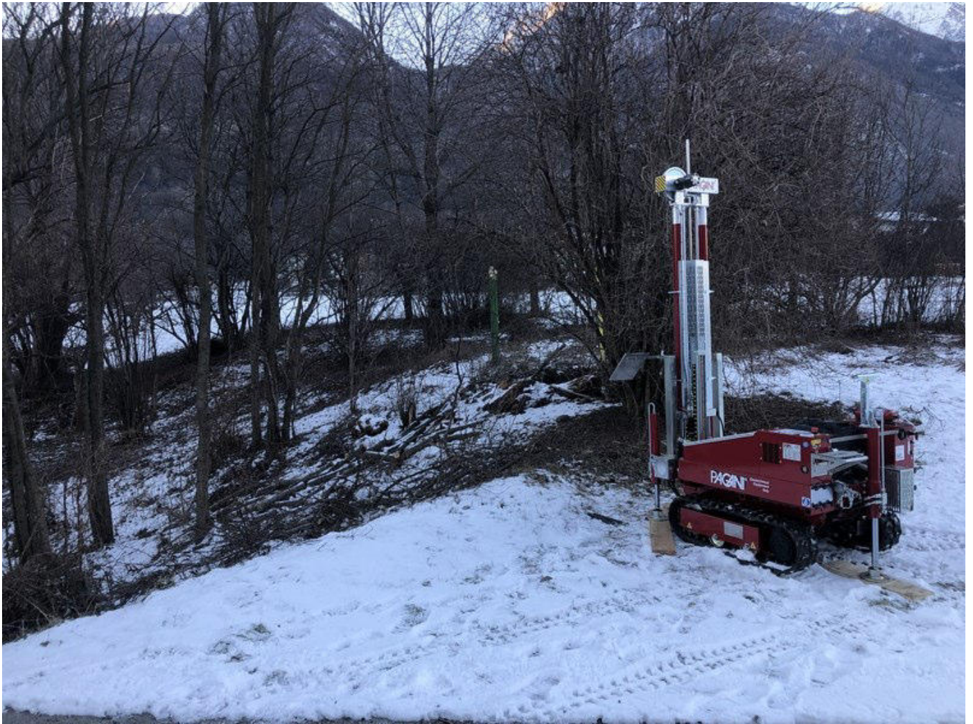
Particolare dell'esecuzione della prova DPSH 12 in prossimità dell'impiuvio a valle della frazione di Surpian (Novembre 2021)
