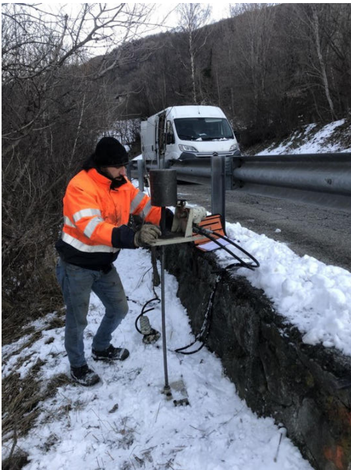
Particolare dell'esecuzione della prova DPSH 12 in prossimità dell'impiuvio a valle della frazione di Surpian (Novembre 2021)
