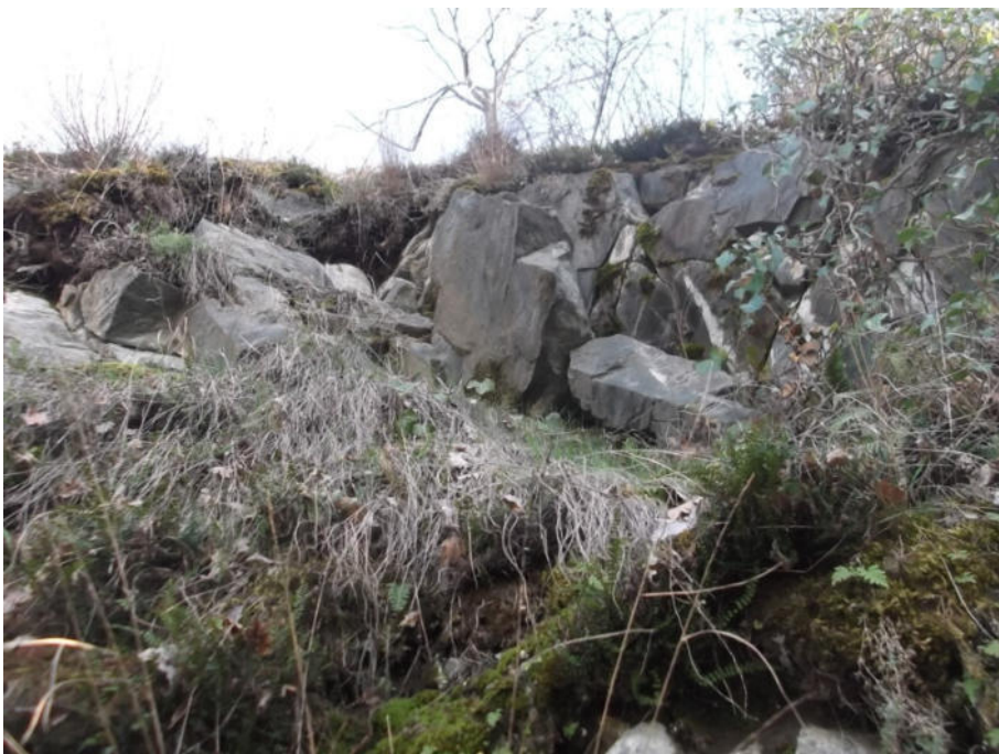
Foto 11: Blocchi penzolanti in corrispondenza del tratto strapiombante della situazione E. Volumi di 0.1mc.
