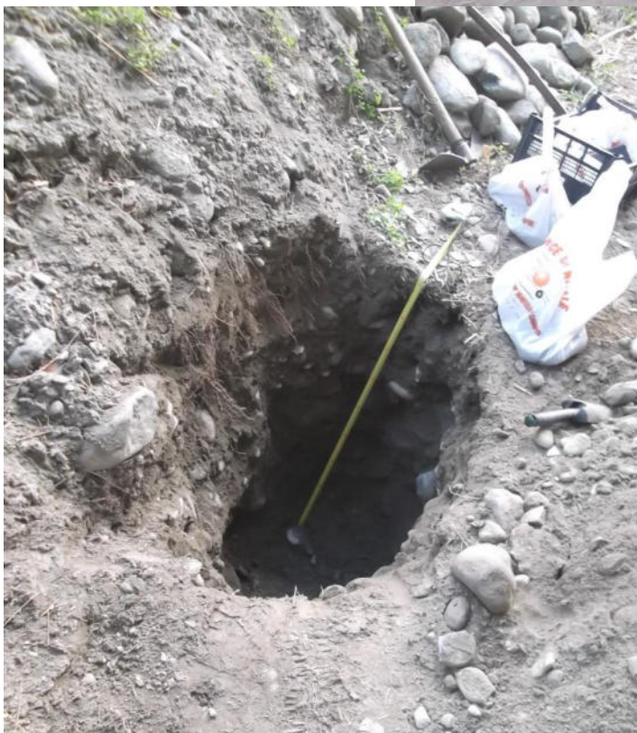
FOTO 6-7-8: scavo dei pozzetti di assaggio per il prelievo dei campioni di terra da avviare all'analisi chimica: si noti la presenza di materiale molto grossolano, ricco di ciottoli e blocchi.
